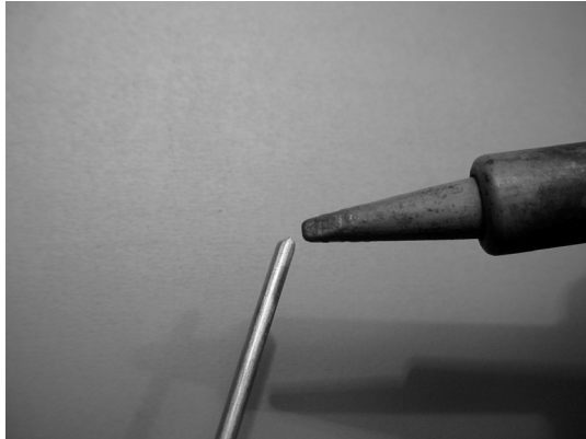
Figura 4.38: Estañe el extremo del alambre antes de soldarlo.
