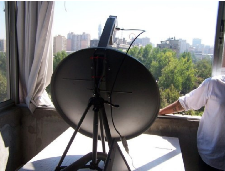
Estación wireless con antena parabólica cuya misión era enlazar el sector marcado con el pequeño círculo para transmitir la FLISOL santiago 2006 mediante flujo continuo de video (streaming) con software libre.
