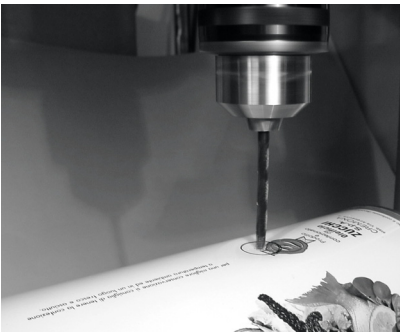
Figura 4.37: Taladre cuidadosamente un agujero piloto, luego use una mecha más grande para terminar el trabajo.
