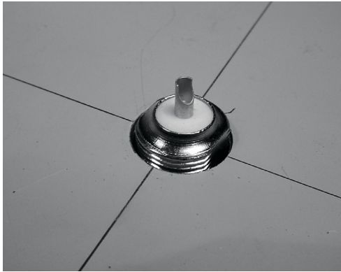
Figura 4.23: El conector N debe encajar exactamente en la perforación.
