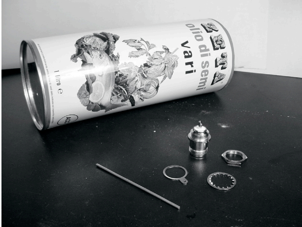
Figure 4.34: Composantes requises pour une cantenna.
