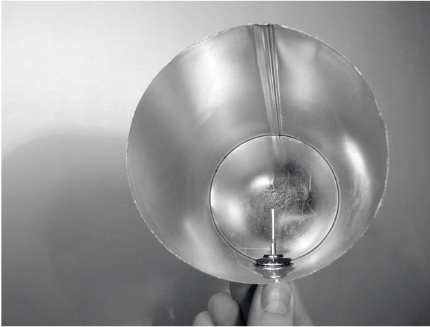
Figure 4.42: Votre cantenna terminée.
