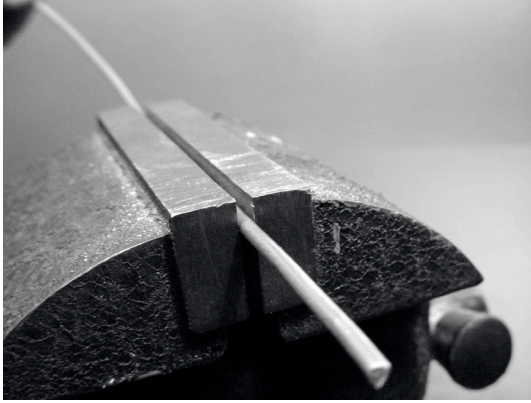
Figure 4.15: Rendez le fil de fer aussi droit que possible.
