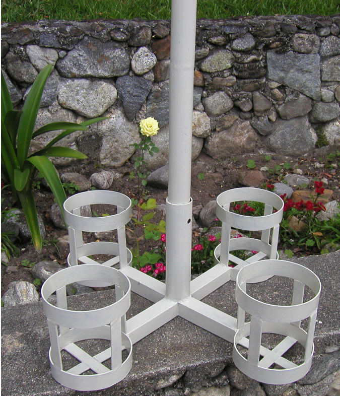
Figure 7.5: Cette base de métal peut être soutenue avec des sacs de sable, des pierres ou des bouteilles d'eau pour rendre la plateforme stable sans avoir à percer le toit.
