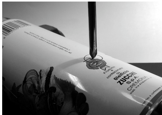
Figure 4.36: Marquez le trou avant de percer.
