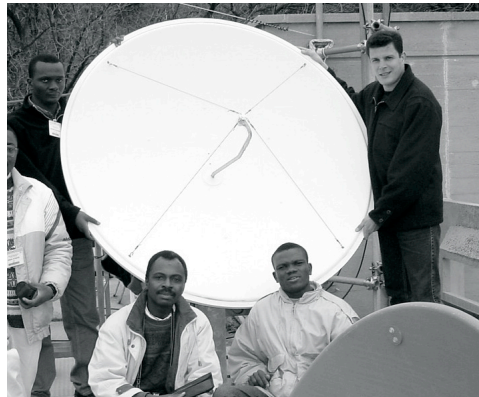
Figure 4.11: Un réflecteur d'antenne parabolique solide.
