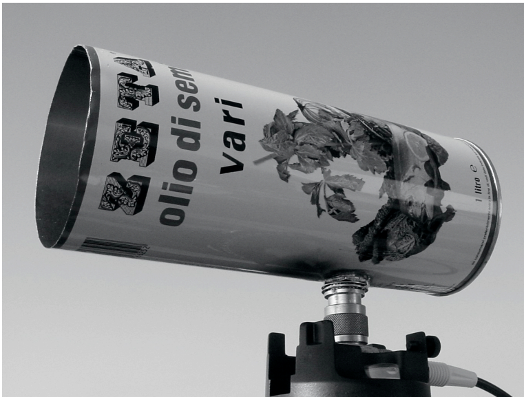
Figure 4.33: Une cantenna finalisée.
