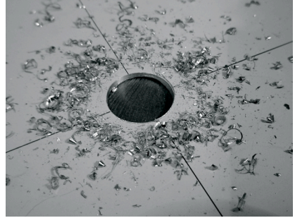
Figure 4.22: Percer un trou dans la plaque métallique.
